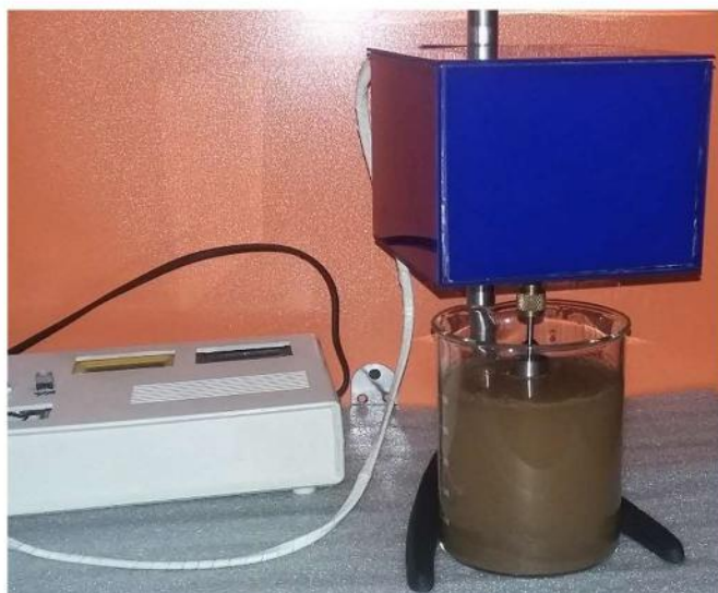
شکل ۱۰. نمایی از دستگاه در هنگام کار به منظور محاسبه ویسکوزیته سوسپانسیون آب و خاک برای محاسبه توان پمپاژ لازم برای شست و شوی سیب زمینی
